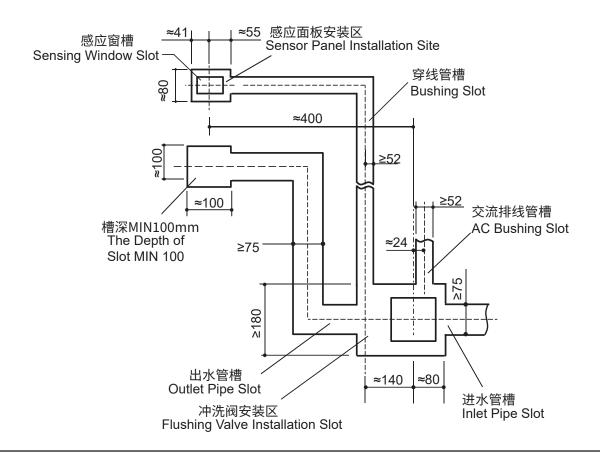
2. 将感应窗排线管分别与暗装架、冲洗阀连接,并放入槽坑内,然后连接好进水管,出水管。用垫紧块将其固定平整、端正,如右图所示,用灰浆填埋槽道,在瓷砖上打孔如图所示,张贴瓷砖。
