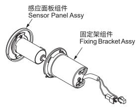
7. 拧下螺钉,揭去灰浆模套,将固定架组件放入暗 装架组件,对准螺钉后逆时针旋转,确认固定架 上的槽为垂直向下后,再锁紧螺钉。
