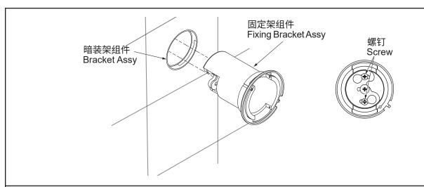
8. 将信号线穿过固定架组件,通过穿线管,进入 阀盒里,面板组件缺口向右下装入固定架组件, 调整至感应窗口垂直,如图所示,用手压住面板 用感应面板钥匙逆时针拨动固定活动板,将感应 面板组件固定。
